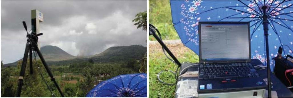
Gambar 22. Pengukuran fluks gas SO<sub>2</sub> Gunung Lokon dengan peralatan MiniDOAS.
